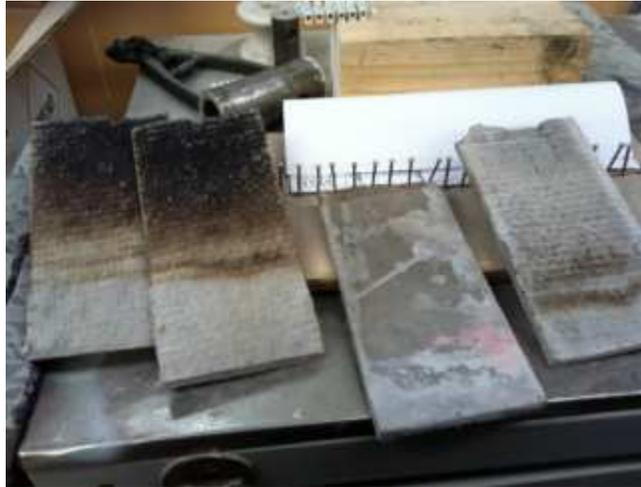
Provini al termine dei test di resistenza a flessione con fiamma
