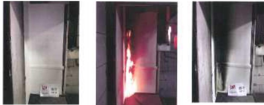
**UNI EN ISO 11925-2** "Prove di reazione al fuoco - Accendibilità dei prodotti sottoposti all'attacco diretto della fiamma - Parte 2: Prova con l'impiego di una singola fiamma".
