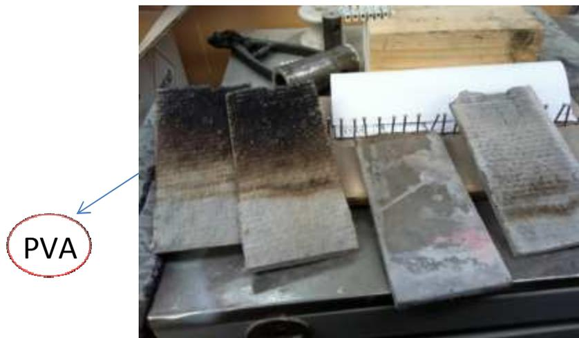
Provini al termine dei test di resistenza a flessione con fiamma
